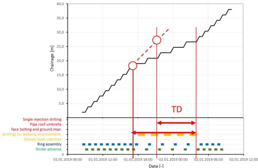
Figur 8. Exempel på tidsfördröjningslista som visar området för hindrad förskott på grund av ytterligare åtgärder och användningen av tidigare prestanda för att bestämma den extra tid som tilldelats entreprenören.
